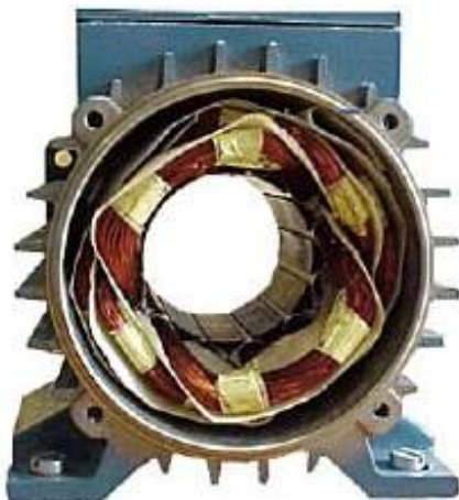
Figure 3 : alésage et bobinage statorique d'une MAS
