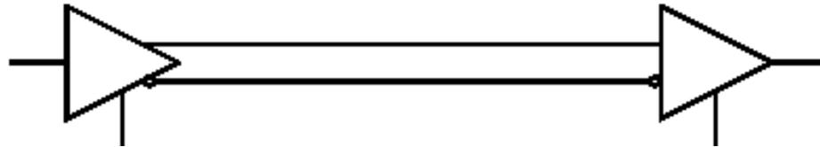
Même si une perturbation électromagnétique dégrade le signal d'un fil, la différence est inchangée, car on suppose que cette perturbation dégrade de la même manière l'autre fil. On réalise ainsi une transmission avec une meilleure immunité au bruit.
