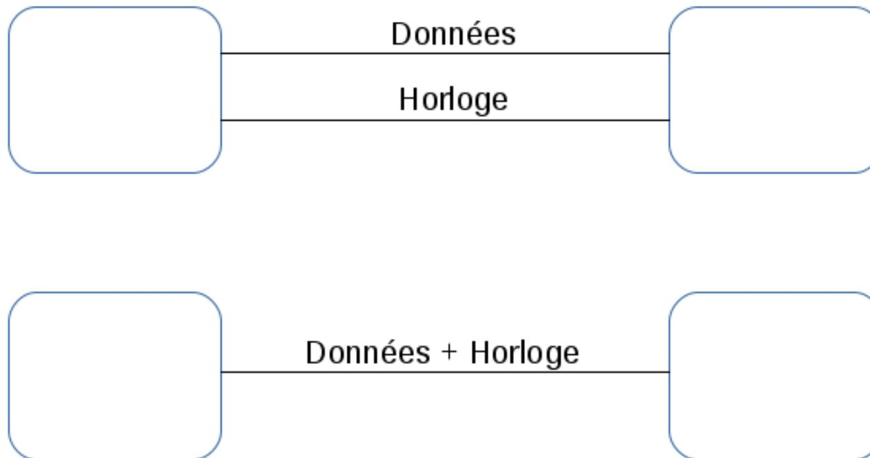
La transmission synchrone permet de transmettre des séquences de bits plus longues ( $n$  octets) appelées **trame**.
