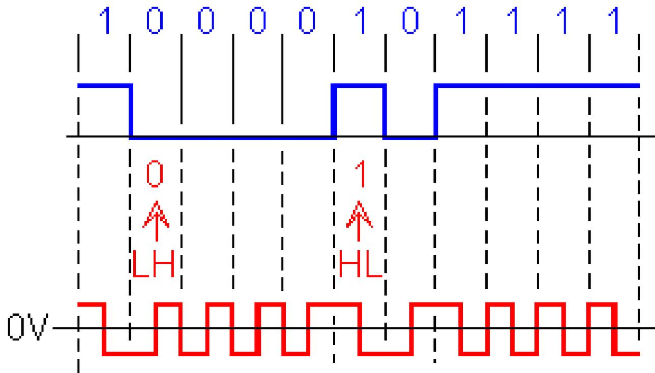
Les transitions du signal codé transmettent à la fois la valeur logique du bit (0 ou 1) et l'instant de son échantillonnage (l'horloge).
